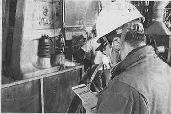
情報通信端末で生産状況を把握する「遠隔モニタリングシステム」
