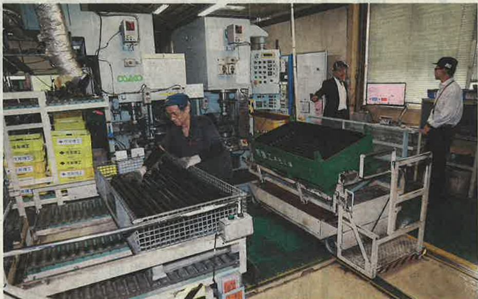
けん引フックの製造ライン。右奥のモニターに稼働状況を映し出す。いずれも碧南市中山町で
